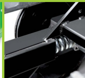
Tenditore cingolo a molla autoregolante Self-adjusting spring tensioner
