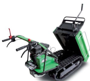
Cassone ribaltabile ed estensibile Tip-up and extensible body
