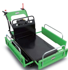
Cassone ribaltabile ed estensibile Tip-up and extensible body
