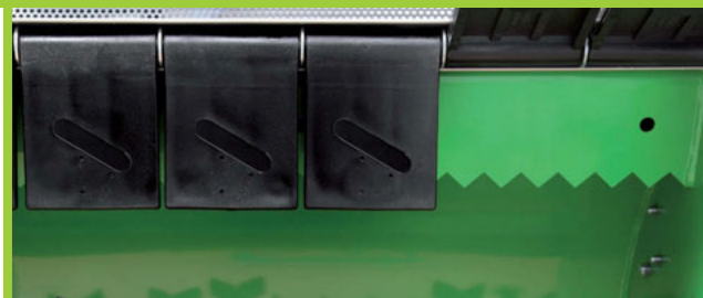
Gruppo di taglio con controcottello e bandelle oscillanti Cutting unit with oscillating safety protections and bottom blade
