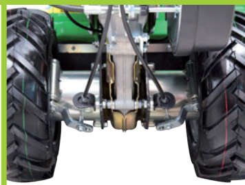
Asse ruote con sbloccaggi indipendenti (accessorio) Wheel axle Independent releases (implement)
