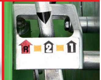
Selettore marce esterno e di facile accesso External and easily accessible gear lever
