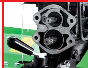
Presa di forza sincronizzata Presa di forza indipendente Synchronised power take off Independent power take-off
