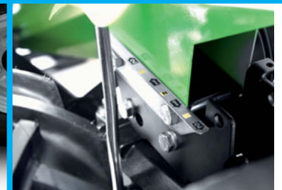
Gruppo cambio in ghisa 2+2 Cast iron gear unit 2+2
