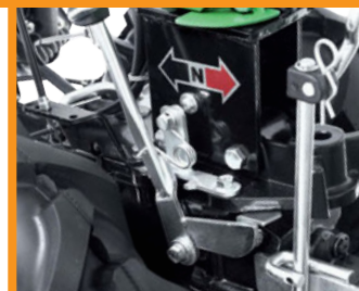
Inversore rapido Quick inverter
