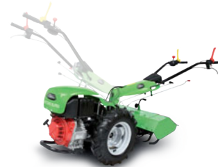
Stegole reversibili orientabili in altezza e lateralmente Height and side adjustable reversible linkage
